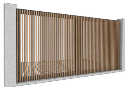
Barreaux en aluminium ton bois et cadre soudé thermolaqué
